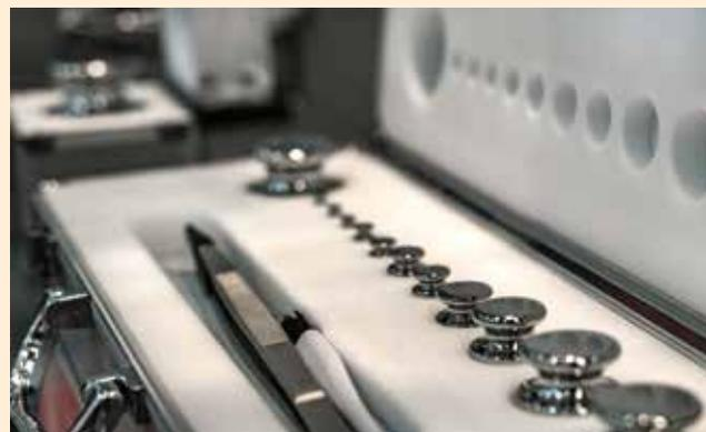
résultats et donc *in fine* en les leurs. L'activité de LaboMasse regroupe plusieurs prestations allant de l'étalonnage (processus qui permet de connaître la valeur réelle du poids), à la vérification (à partir de 1 mg, elle ne peut avoir lieu que si un étalonnage a été réalisé préalablement). Ces deux processus représentent 80% de notre activité. Si la vérification démontre une non-conformité du poids, le laboratoire procède à un ajustage (qui permet d'ajouter ou de retirer de la matière).
